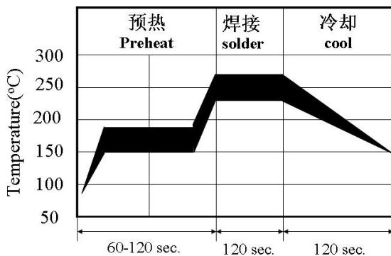
注意：如果回流焊温度超过图表建议最高温度（260°C），元件可能损坏而达不到规范要求。
